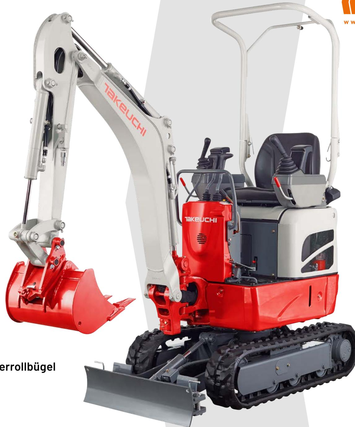
**Das kompakte Design und der kleinste Schwenkradius auf beide Seiten erlauben dem Kurzheckbagger TB210R auch auf engstem Raum uneingeschränktes Arbeiten.** Mit einer Breite von nur 750 mm und dem klappbaren Überrollbügel passt der Kleinste der TAKEUCHI Familie durch jede Tür, überzeugt aber gleichzeitig mit maximaler Standsicherheit dank des hydraulisch verbreiterbaren Fahrwerks.
